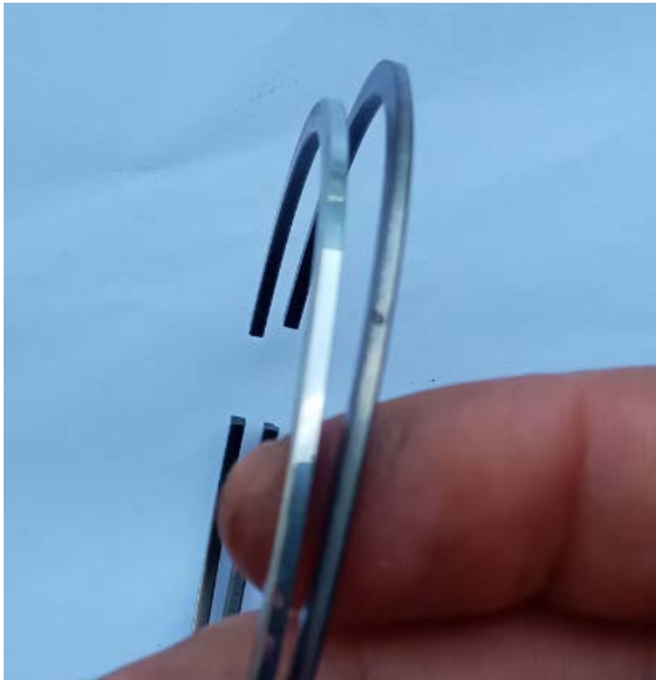
Figura 7.30 Cilësia sipërfaqësore e dy unazave hermetizuese.
