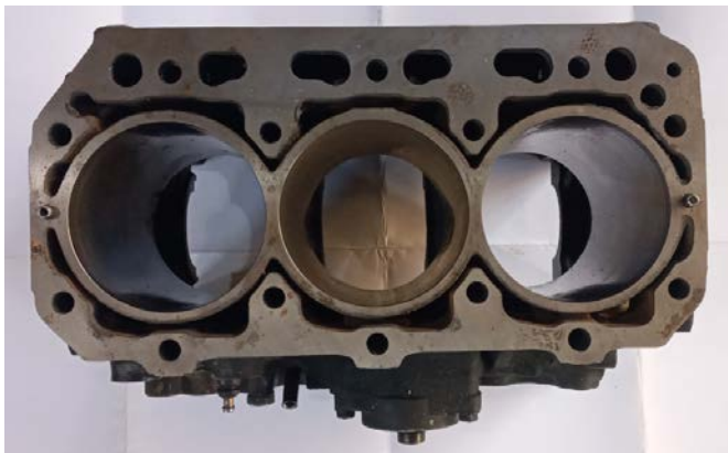
Figura 7.9 Blloku i cilindrave ku bien në sy këmishat, të lagura dhe të derdhura sëbashku me bllokun (me presion).
