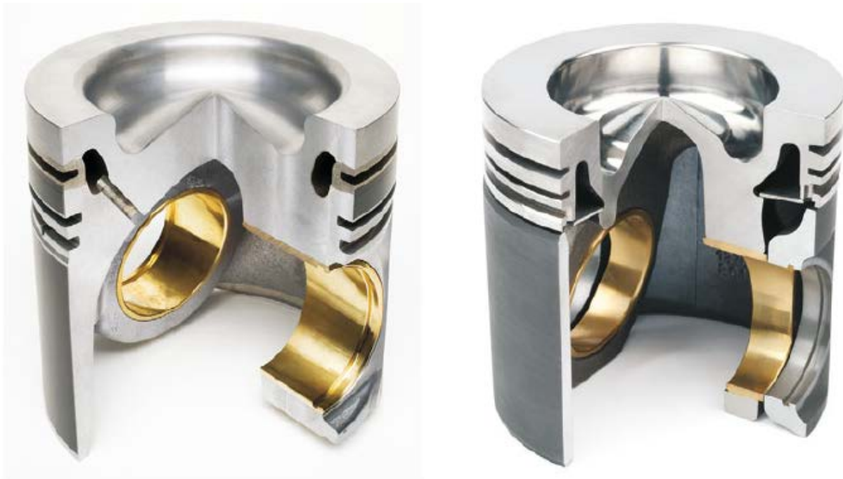
Figura 3.3 Piston i pajisur me bokulla bronzi te montuara tek syri i tij. Figura majtas tregon edhe perforcimin e kanalit te unazes se pare. Figura djathtas ilustron nje piston pe perbere nga dy pjese, kemisha eshte prej materiali ferroz ndersa kurora prej legure alumini [62]
