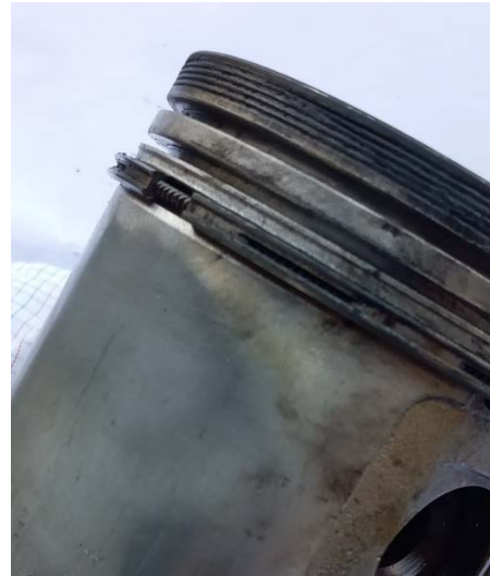
Figura 7.11. Pistoni me kanalet dhe unazën e vajit e perbere nga dy pjese.
