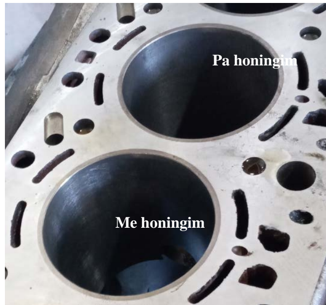
Figura 7.25 Diferenca e cilindrit të retifikuar dhe atij që i është aplikuar edhe honingimi.
