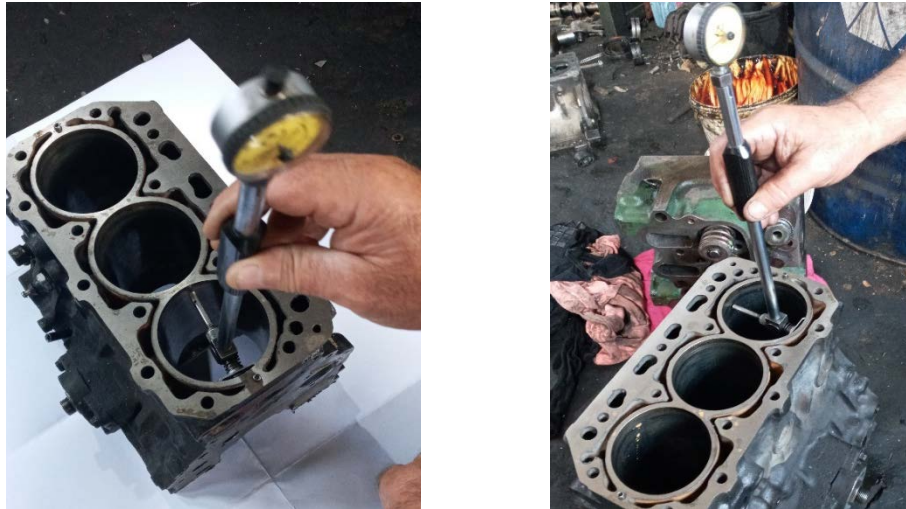
Figura 7.15 Matja e konicitetit (majtas) dhe ovalitetit (djathtas) tek blloku i cilindrave.
